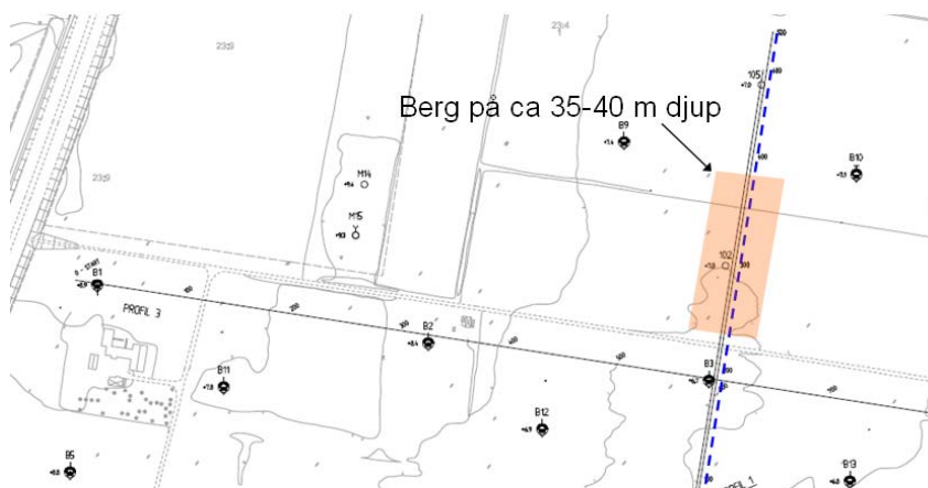
Figur 4.1 Plan – berg inom 35-40 meter markerat. Övriga delar av området ligger troligen berget djupare.
