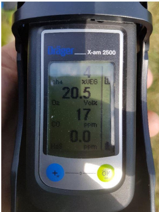
Figur 8. Gasmätarens display under mätning av gas i provpunkt NC3.
