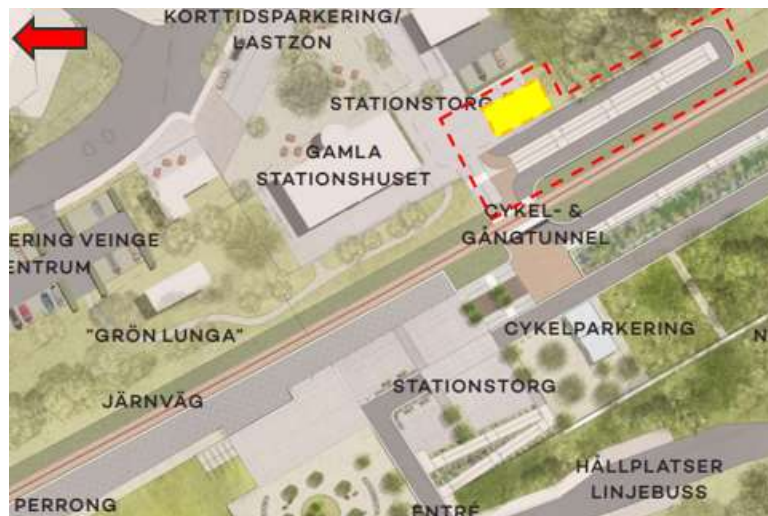
Figur 1. Illustrationsplan över stationsområdet. Planerad trappa, ramp inom röd streckad markering. Planerad ny byggnad inom gul polygon. (Källa: Laholms kommun, 2023)
