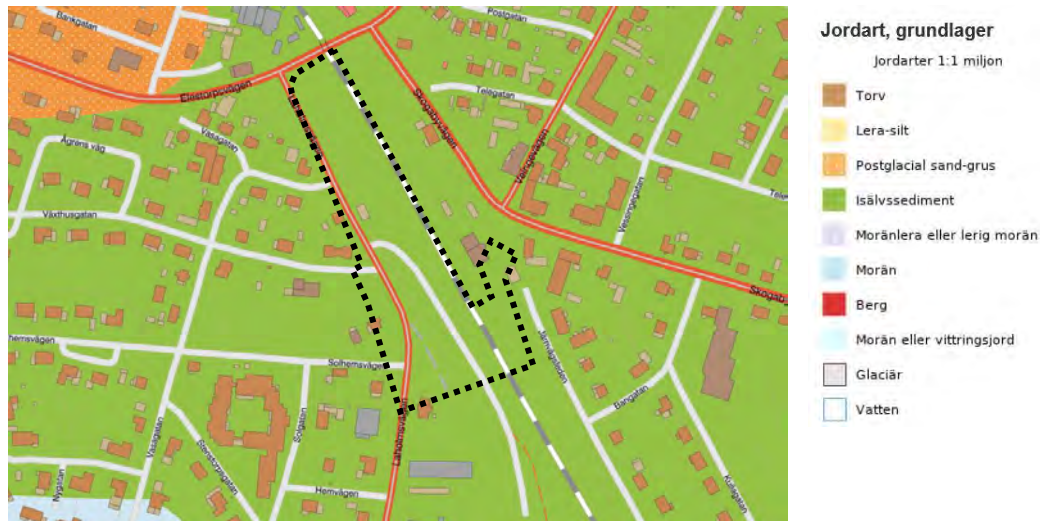
Figur 4. Utdrag ur SGU:s digitala jordartskarta. Undersökningsområdet är markerat med svart streckad linje. Kartan visar att de naturliga jordarterna på fastigheten utgörs av isälvsediment). © Sveriges geologiska undersökning.
