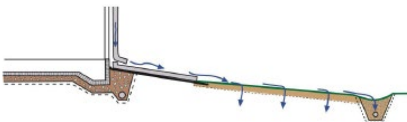
Exempel på hur dagvatten kan avledas med hjälp av stuprörsutkastare och dräneringsstråk. Dräneringsstråket läggs på den egna fastigheten, Svenskt vatten P105 .
